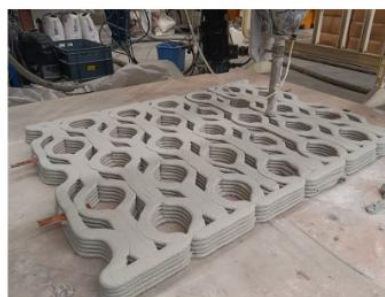
Panel sensorizado con mortero conductor
